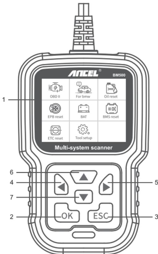
1. AFFICHAGE LCD - Indique les résultats des tests. Écran rétroéclairé de 320 x 240 pixels
