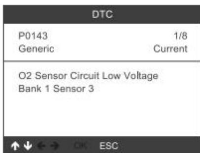
Le numéro du module de commande, la séquence des codes d'anomalie, le nombre total de codes détectés et le type de codes (générique propre au fabricant) sont indiqués en haut à droite.
