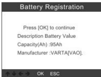
**4.2. Choisissez une nouvelle capacité de batterie et un nouveau fabricant:**
