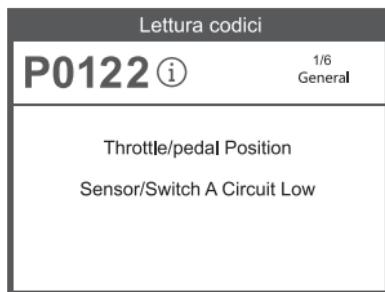
2) Solo quando si utilizza la funzione di lettura del codice e l'icona ⓘ appare sullo schermo, puoi premere questo tasto I/M / ⓘ per realizzare la query di definizione del codice di errore. Lo schermo visualizzerà l'interfaccia come mostrato di seguito:
