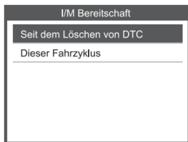
I / M-Bereitschaft ist es, Fehlzündung / Kraftstoffsystem / umfassende Komponente zu testen, Sie Sie können mit den Tasten AUF oder AB auswählen und OK drücken. Dies wird wie folgt angezeigt:
