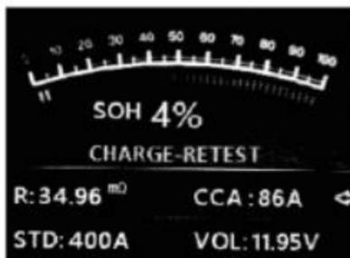
Le batterie instabili devono essere ricaricate e testate nuovamente per evitare errori. Se si verificano gli stessi risultati del test dopo ricarica e ritardo, la batteria viene considerata danneggiata e la batteria viene sostituita.
