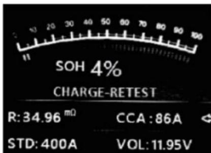
Las baterías inestables deben recargarse y volver a probarse para evitar errores. Si aparece el mismo resultado de prueba después de la carga y la nueva prueba, la batería se considera dañada y la batería se reemplaza.
