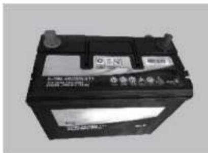
CCA: amplificador de paso frío especificado por SAE y BCI, el valor de unidad de inicio más comúnmente utilizado es  $-18^{\circ}\text{C}$  ( $0^{\circ}\text{F}$ ). BCI: estándares internacionales para el Comité de Batería.
