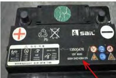
CCA: amplificador de etapa fría designado por SAE y BCI, la batería de arranque más comúnmente utilizada es 0 ° F (-18 ° C).
