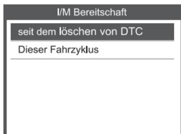
I/M Bereitschaft ist, Fehlzündung/Kraftstoffsystem/umfassende Komponente zu testen, Sie können mit UP oder DOWN wie folgt auswählen und ENTER drücken:
